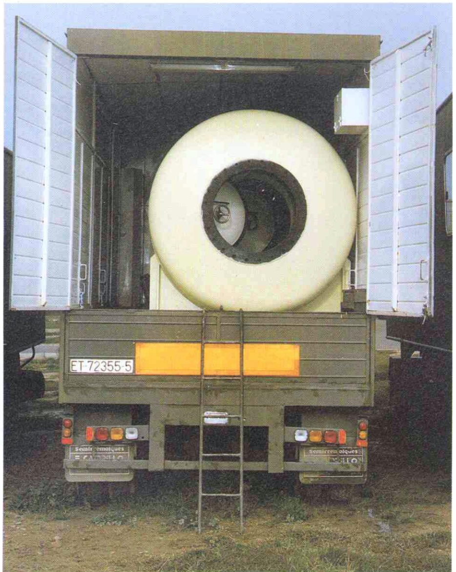
Cámara hiperbárica multiplaza montada sobre remolque.
