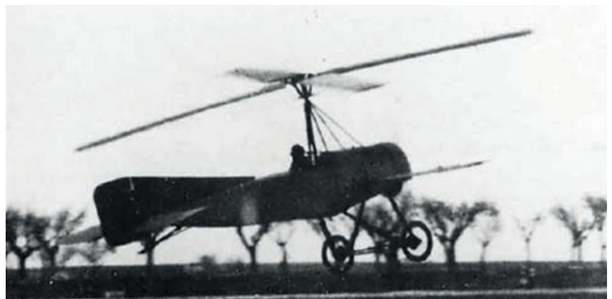
El C1, primer prototipo de autogiro que no consiguió volar. Getafe, octubre de 1920
