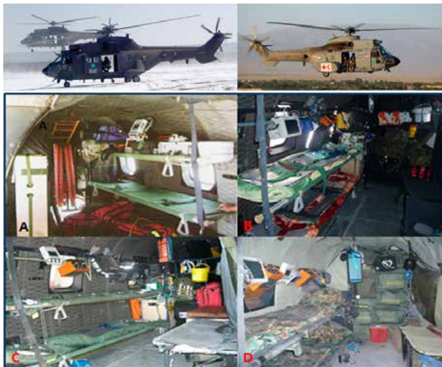
Figura 3: Izquierda: Helicóptero Cougar del Ejército de Tierra español en versión ambulancia. Derecha: Helicóptero Super Puma del Ejército del Aire español en versión ambulancia. Imagen A-D: Evolución de la configuración interna de los aparatos de ala rotatoria españoles
