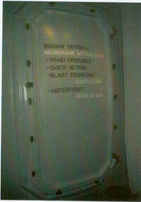
Puerta imbloqueable, presentada por TNO-PML, idéntica a las que monta la Álvaro de Bazán . (Foto: A. Campanera i Rovira).
