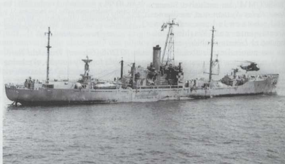
El Liberty el día siguiente al ataque y durante el trasbordo de heridos por helicóptero. Pueden apreciarse el asiento aproante causado por la inundación de la bodega n.º 3, el dispositivo general de antenas y (entre la superestructura y toldilla) la antena de plato del TRSSCOMM. (Foto: Marina norteamericana, probablemente obtenida desde el portaaviones America ).
