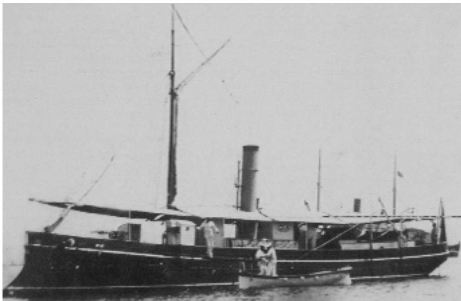
La Cónдор llevó en un principio aparejo de balandra, que más tarde se cambió por uno de pailebot.
