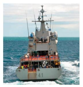
El Sistema de Combate integra la información de los distintos sensores (Radar de exploración aérea y de Control de helicópteros; Radar de navegación; Dirección de tiro optrónico-radárica *DORNA*; Sistema de vigilancia optrónica; Sistema ESM; Sistema IFF; *Data Link*, etc...) y armas (un montaje de 76 mm y dos montajes de 25 mm con capacidad de realizar combate múltiple).
