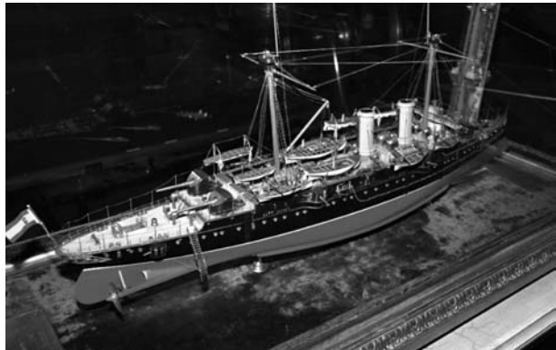
Figura 9.— Una vista de aleta del Reina Regente en la que se puede apreciar su baja toldilla y la fina forma de su sección popel. (Museo Naval. Madrid).
