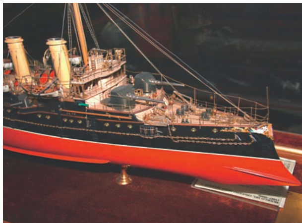
Figura 1.— Sección de proa del modelo de arsenal del crucero Reina Regente . Pueden apreciarse algunas de sus peculiares características de diseño, como la forma afilada de su sección de proa, el escaso francobordo del castillo, la disposición de la artillería principal, los reductos de cañones Nordenfolt casi a ras de agua por debajo de la artillería principal, la disposición muy a proa y a escasa altura del puente de combate (debajo del puente de navegación) y la gran cantidad de manguerotes o tubos de ventilación mirando hacia proa en el castillo y la cubierta alta, causa potencial de vías de agua en un temporal. (Museo Naval. Madrid).
