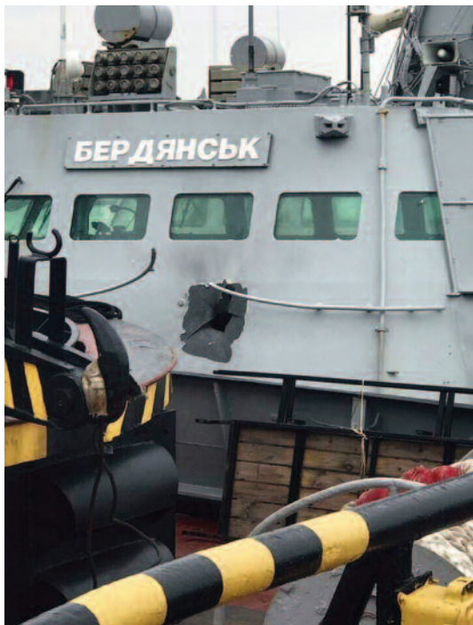
Superestructura del patrullero ucraniano Berdyansk (P-175), en la que se pueden ver los daños producidos por el impacto de un proyectil ruso el 25 de noviembre de 2018. (Foto: www.wikimedia.org ).
