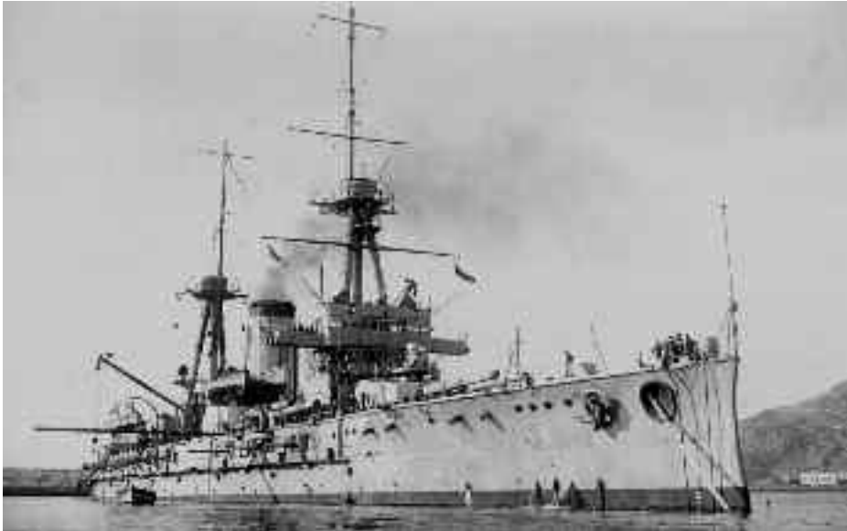
Uno de los acorazados clase España , que marcaron toda una revolución tanto por su construcción como por sus modernos sistemas de tiro. (Colección Aguilera, Museo Naval de Madrid).
