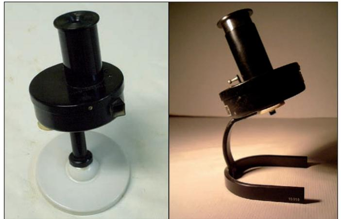
**Figura 11:** Los dos modelos de colorímetro Zeiss Ikon estudiados. A la izquierda el modelo D, el sacarímetro con pie de peana redonda y a la derecha el modelo A, el hemoglobínometro con pie de herradura.
