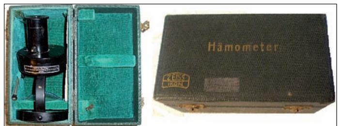
**Figura 12.** Estuche del hemoglobínometro. En la foto superior puede apreciarse la cubeta de cristal, la varilla limpiadora y un vidrio de reloj, habiéndose perdido la pipeta que iría sujeta en la tapa junto a las bisagras.
