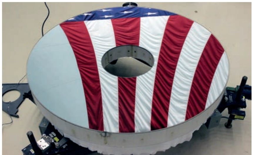
El espejo principal del telescopio NGRST. (Imagen: L3 Harris Technologies)
