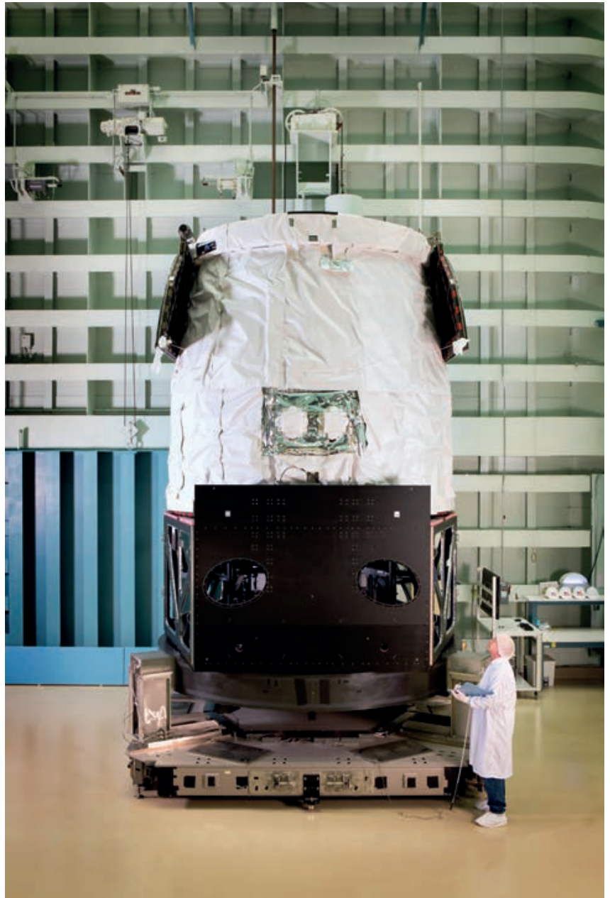
La estructura de soporte del espejo principal (OTA). (Imagen: Dave Sime/Harris Corporation/JJT)
