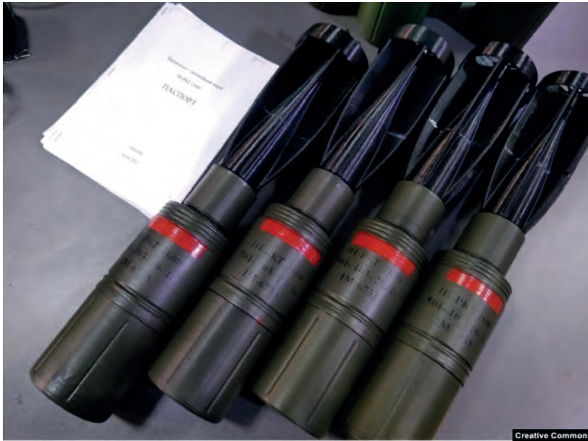
Granadas antitanque RKG-3 de la era soviética modificadas con aletas traseras impresas en 3D para estabilizar su caída desde los drones. (Imagen: Aerorozvidka)
