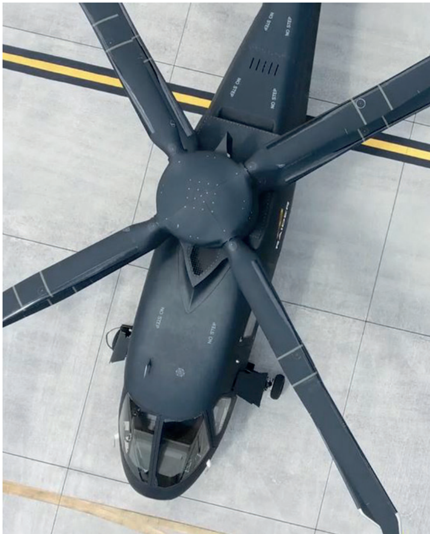
Imagen en planta del S-97, mostrando las soluciones de baja observabilidad del motor, idénticas por el momento a las del Raider X. (Imagen: Lockheed Martin)
