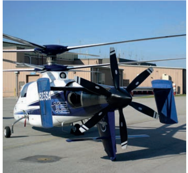
Vista trasera del X2 con la hélice Pusher en primer plano. (Imagen: Sikorsky)
