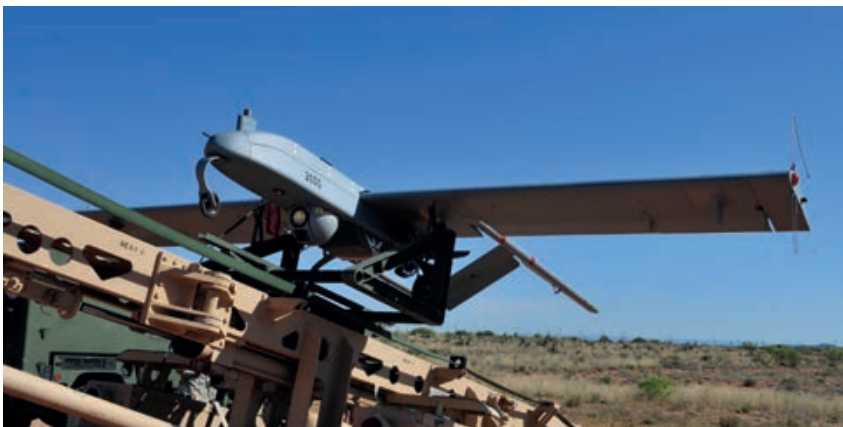
Un Shadow RQ-7B versión 2 instalado en un lanzador hidráulico. (Imagen: US Army)
