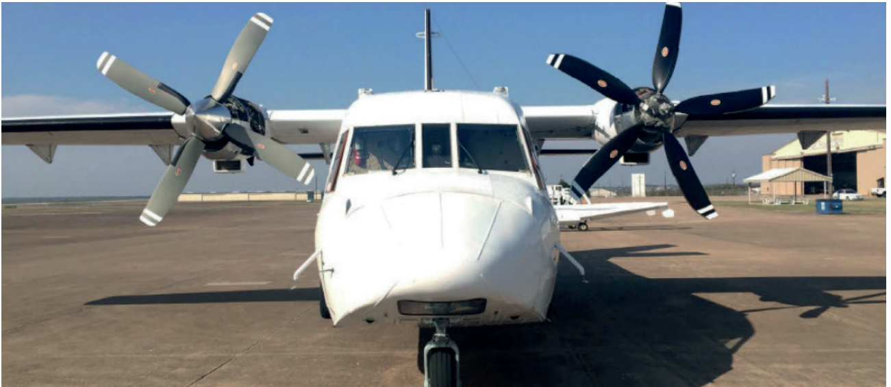
Comparativa de hélices de cuatro y cinco palas
