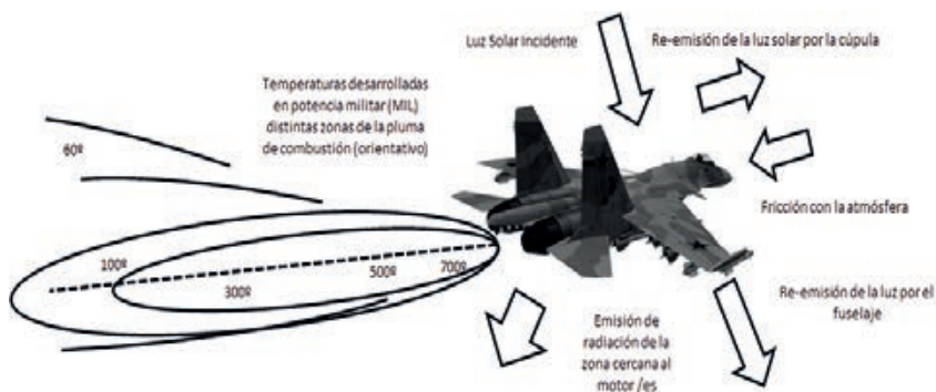
Radiación infrarroja en una aeronave y temperaturas de la pluma de combustión. (Imagen: autor)
