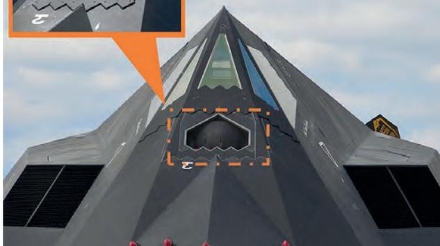
que recubre la admisión de los reactores (cuyos agujeros son de menor diámetro que la longitud de onda de los radares de posibles adversarios) y la aplicación de materiales RAM en las diversas juntas entre paneles.
