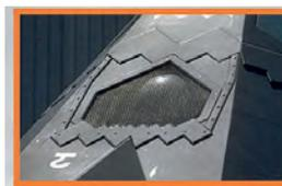
Frontal del F-117. Se aprecia la malla de la tobera de admisión y la compuerta de admisión auxiliar, así como el FLIR. Imagen de Cory W. Watts
