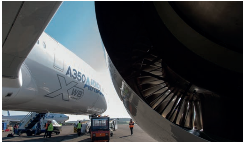
Motor Trent XWB para el A350.
