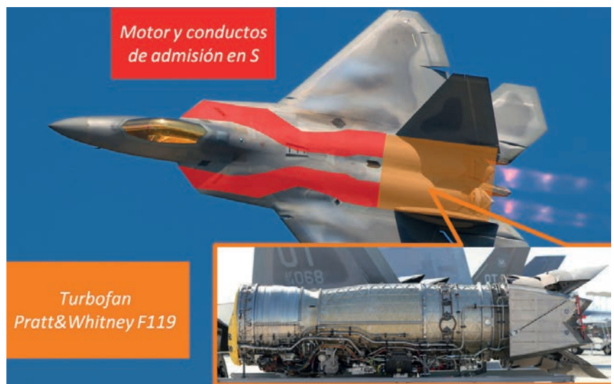
Imagen 2: Representación de los conductos de admisión y motor PW-119-100 sobre imágenes de la USAF.
