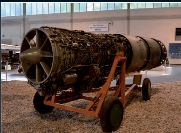
ESTE ES EL MOTOR AL-21F-3 "SATURNO" ("LYULKA"), UN TURBORREACTOR DE FLUJO AXIAL DE 24.675 LIBRAS DE EMPUJE, PROVISTO DE POSTQUEMADOR, QUE PROPORCIONABA FUERZA AL MIG-21.
