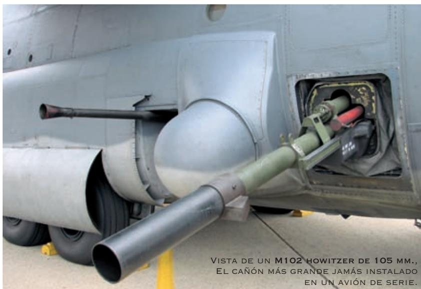
VISTA DE UN M102 HOWITZER DE 105 MM., EL CAÑÓN MÁS GRANDE JAMÁS INSTALADO EN UN AVIÓN DE SERIE.
