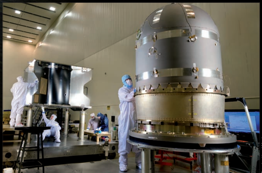
El tanque de hidracina y la estructura de la sonda, listos para ser ensamblados.
