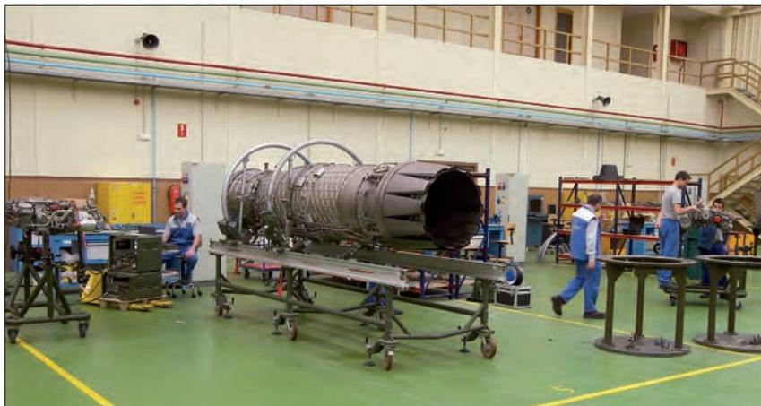
Actividades de mantenimiento de ITP en el taller de motores del Ala 11. ITP, mediante un contrato de prestaciones, realiza el mantenimiento de segundo escalón del 50% de los motores del Ala 11, mediante sustitución de módulos (métrica: número de días de reparación del motor). El EA, para mantener la capacidad de despliegue, realiza el 50% restante.
