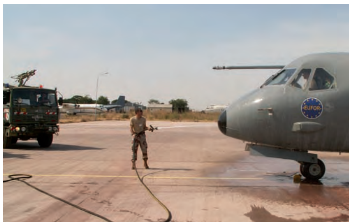
Lavado de compresores.
