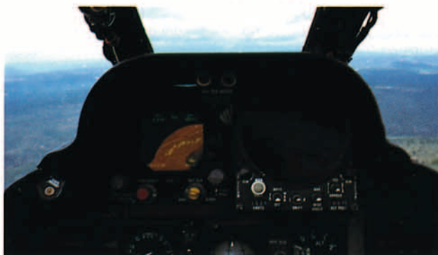
La opción "seguimiento del terreno" del radar APQ-172, permite al CR-12 navegar en baja cota en condiciones, incluso, de nula visibilidad.
