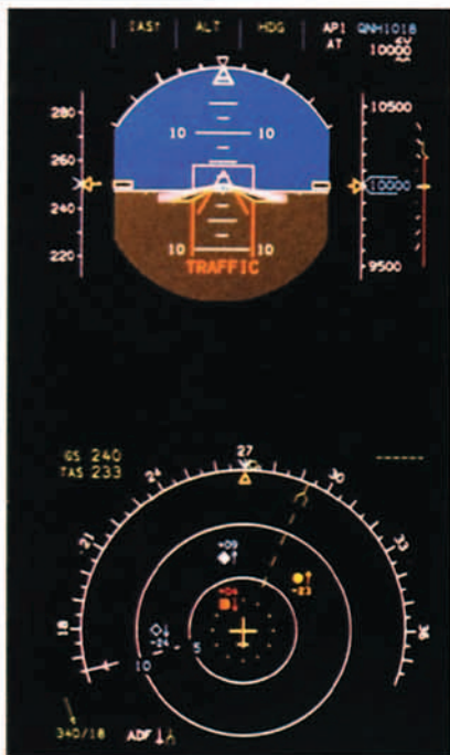
Presentación TCAS de Fokker en la que la guía para maniobras verticales se encuentra en la presentación primaria de vuelo. En la imagen de navegación (abajo) se muestra al tránsito intruso.
