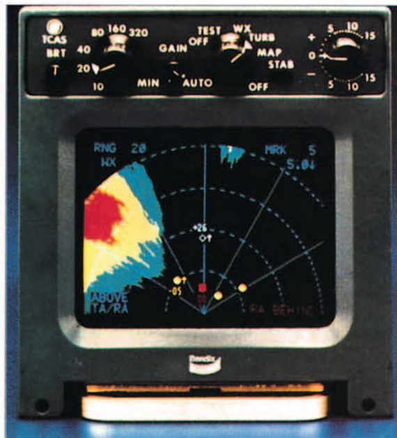
Presentación en cabina de una amenaza a menos de 2 millas, a las 12:00 de posición y al mismo nivel (ésta dará un Aviso de Decisión RA) y una posible amenaza a las 10:00 de posición, 500 pies por debajo y ascendiendo (ésta dará inicialmente un Aviso de Tránsito TA).
