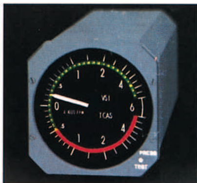
Variómetro de Kollsman con presentación de Avisos de Decisión RAs.
