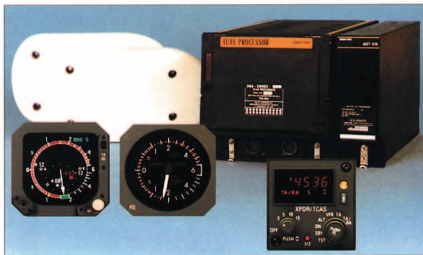
Procesador TCAS de Bendix/King, antenas, respondedor y dos tipos de presentación. El de la izquierda es un variómetro con una presentación integrada de Avisos de Tránsito (TA,s) y Avisos de Resolución (RA,s). El de la derecha presenta Avisos de Decisión (RA,s) mediante un código de luces.
