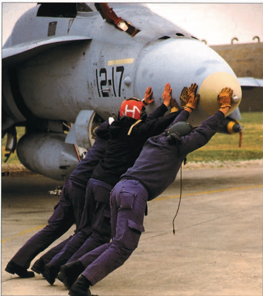
Lo reducido del espacio disponible para los aviones obliga a aparcarlos "a mano" aumentando el ya de por sí elevado ángulo de giro del F-18.
