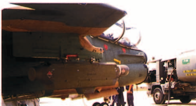
Detalle del ALQ 131 (V), el POD ECM que porta bajo el ala el A-7 Corsair portugués.
