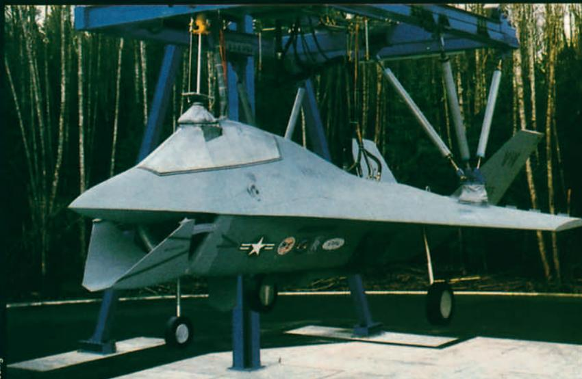
Boeing construyó una maqueta de su JSF a escala 94%. En total ha realizado unas 12.000 horas de diversos ensayos, incluidos los de esta maqueta.
