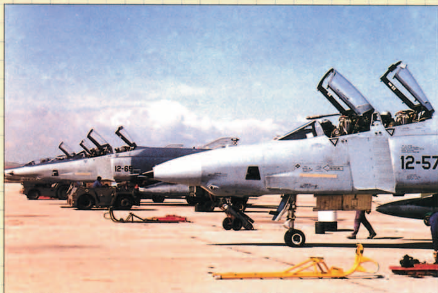
Es conveniente equipar las plataformas con una variedad de sensores de tal forma que faciliten una flexibilidad ante variaciones tácticas y meteorológicas. El RF-4C tiene capacidad de actuar simultáneamente hasta cinco sensores con diferentes características.
