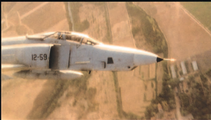
La sonda de reabastecimiento del RF-4C es un desarrollo de la industria israelí para su Fuerza Aérea, cuya licencia para incorporarlo a nuestra Flota, fue adquirida por el Ejército del Aire en el año 1992.
