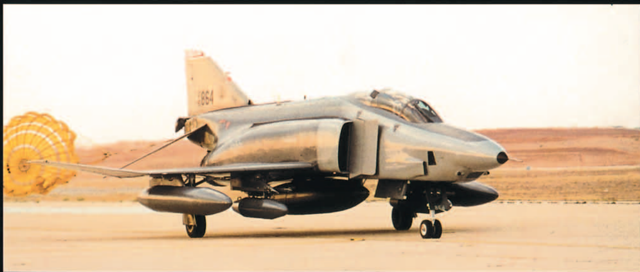
Obsérvese el lanzador del misil "AIM-9L Sidewinder" en la estación de "inboard" derecho.
