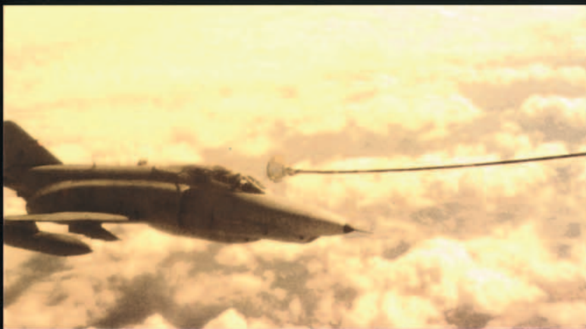
El RF-4C es el único sistema de armas en España capaz de reabastecer, o bien con cisternas provistas del sistema manguera/cesta (como aparece en la foto), o bien con cisternas provistas de "boom", debido al "hard point" en el lomo del avión con el que viene desde fábrica.
