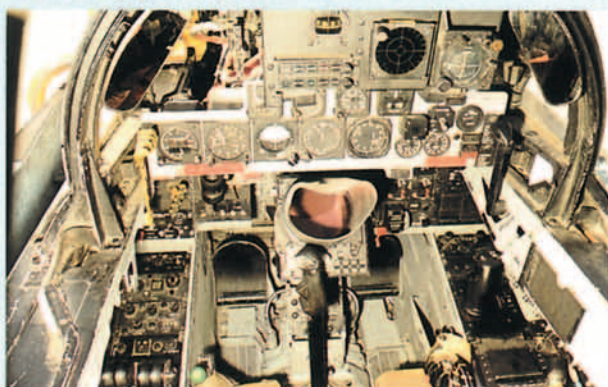
Detalle de la cabina trasera del OA (Operador de Armas). Entre otros equipos, lleva el control del NWDS (Navigation and Weapon Delivery System), del radar APQ-172 y de las cámaras.
