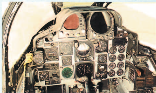
Detalle del panel principal de la cabina delantera. El RF-4C tiene posibilidad de usar VOR, TACAN e ILS como ayudas a la navegación. A parte de un inercial de giróscopos láser de gran precisión (NWDS) de múltiples posibilidades para la navegación.
