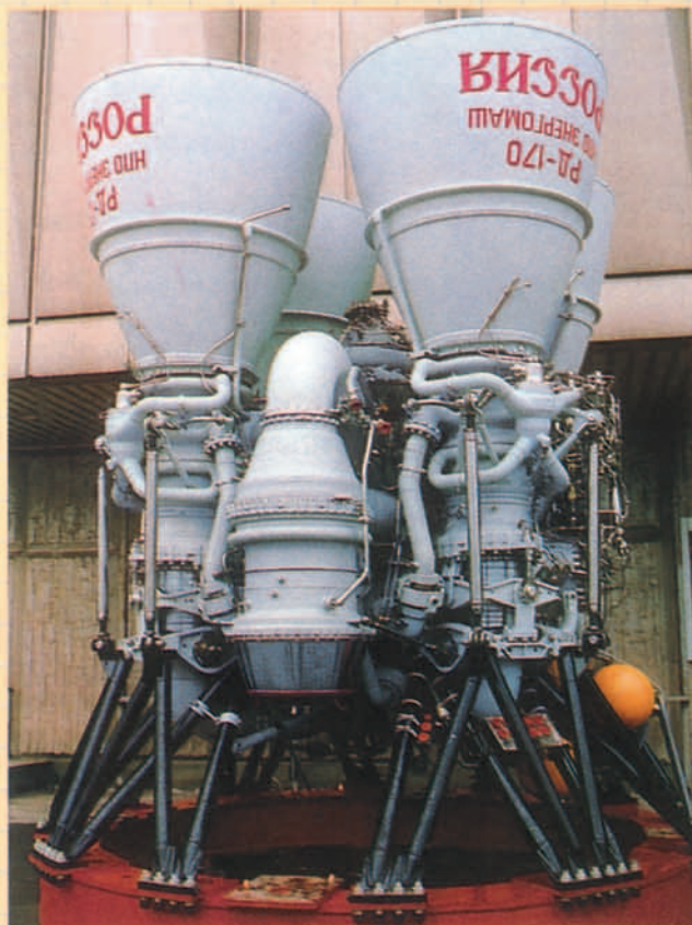
Figura 1. Pratt Whitney USA ha comercializado con Rusia su motor cohete RD-170 de propulsante oxígeno/keroseno, que produce 1.777.000 libras de empuje. Con la denominación NPO-EM (Energomash), será aplicado por Rusia para el lanzamiento con sus sistemas Zenith y Energía.
