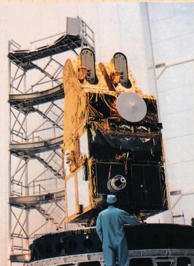
Figura 3. Satélite SPOT 4 para observación de la Tierra en múltiples misiones; actualmente en fase de integración y cualificación por Matra Marconi Space en Toulouse. Estará disponible para lanzamiento en 1995.
