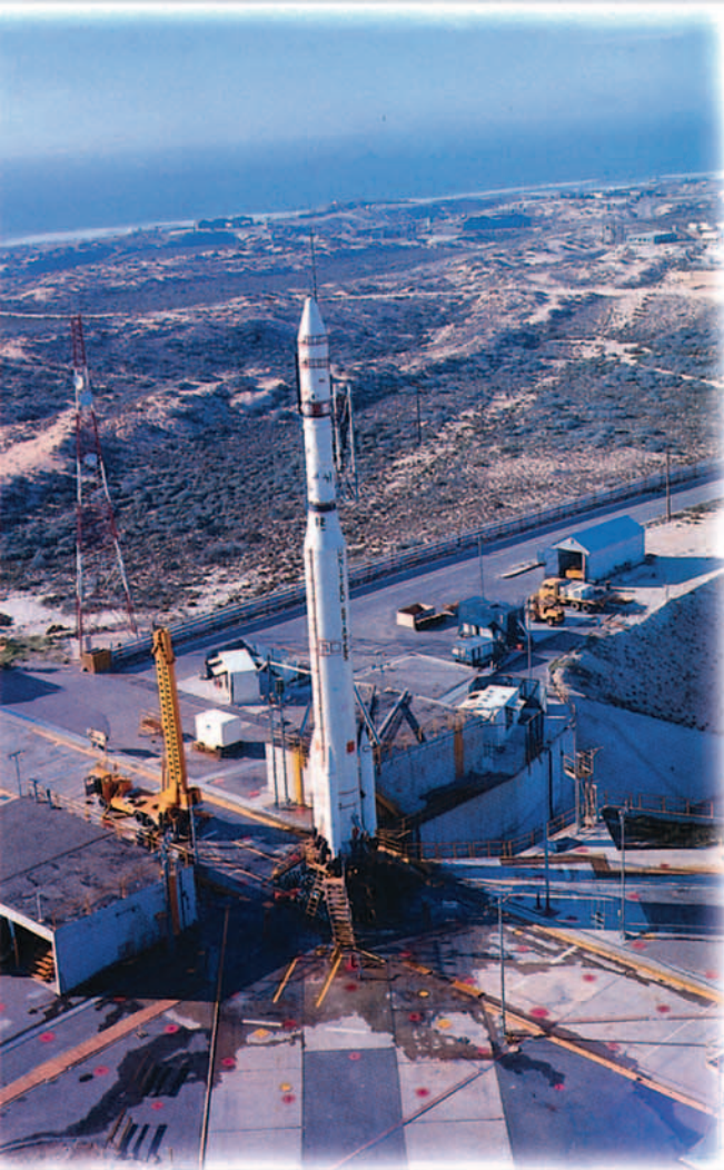
El vehículo experimental SERT-2, que debía ensayar diversas técnicas de propulsión iónica, en el pad de lanzamiento junto a su vehículo portador, un Thor DSV-2A/Agena-D.
