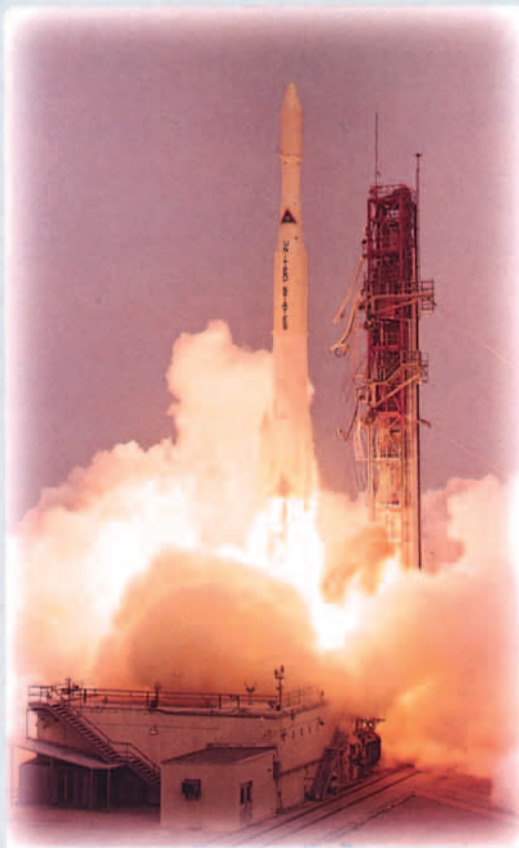
Un cohete Delta, una de las aplicaciones para la NASA del misil Thor, que posteriormente sería ampliamente utilizado en multitud de versiones. En la imagen, el lanzamiento del Pioneer-E.
