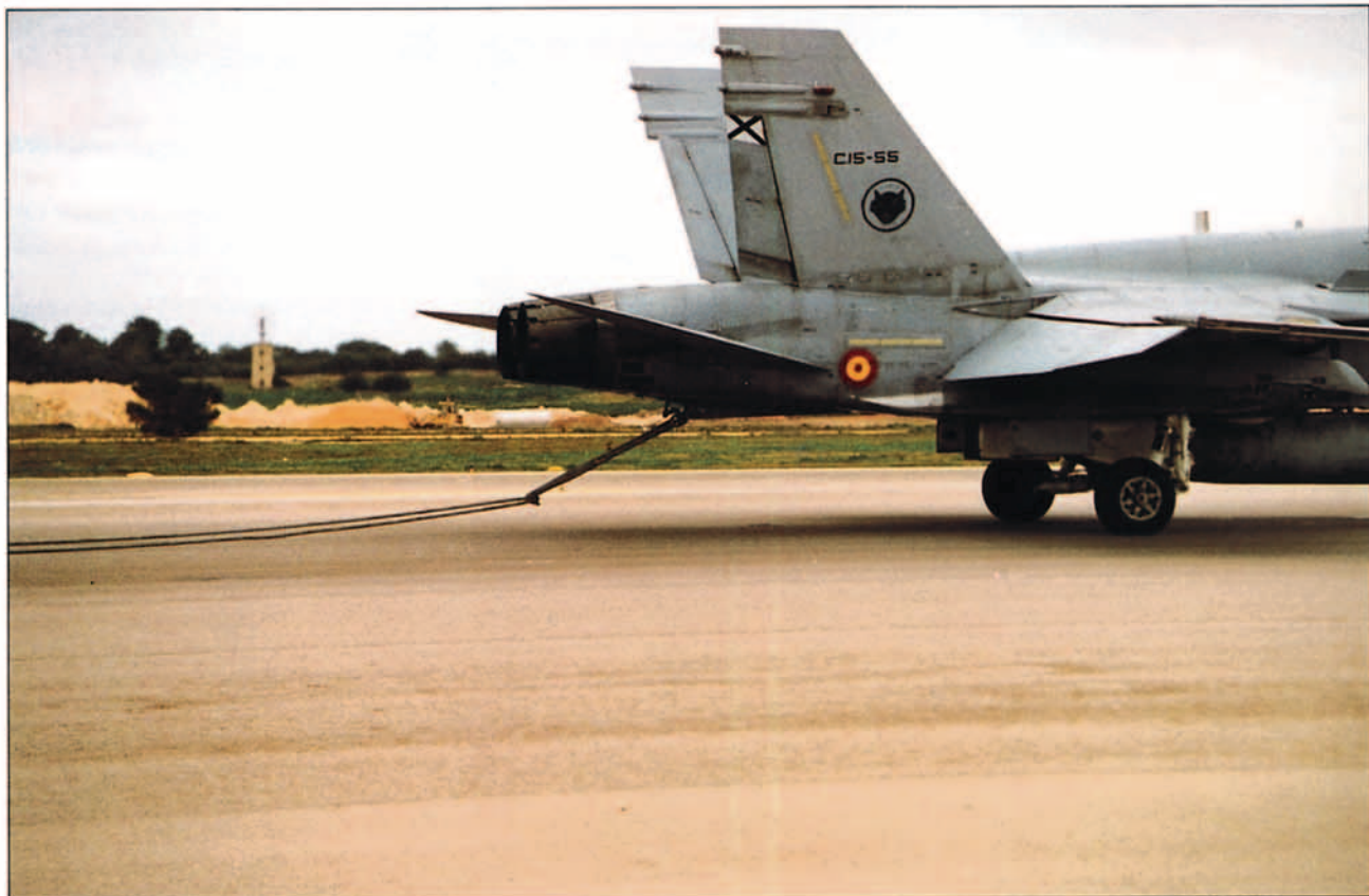
Detalle del gancho del F-18 y el cable de la barrera.
