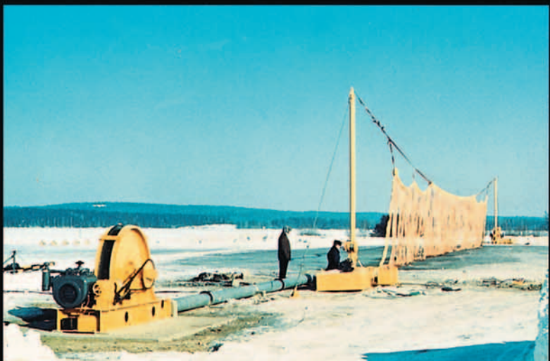
Red izada en climas fríos en la base aérea de Kuopio (Finlandia).
