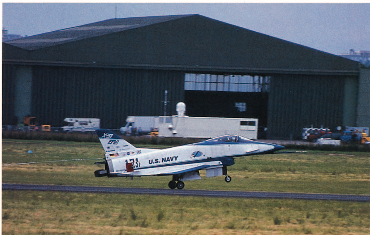
Toma de tierra del X-31. Nótese la ausencia de flaps, los deflectores de flujo y la leyenda de «U.S. NAVY» colocada para la ocasión sin razón aparente.
