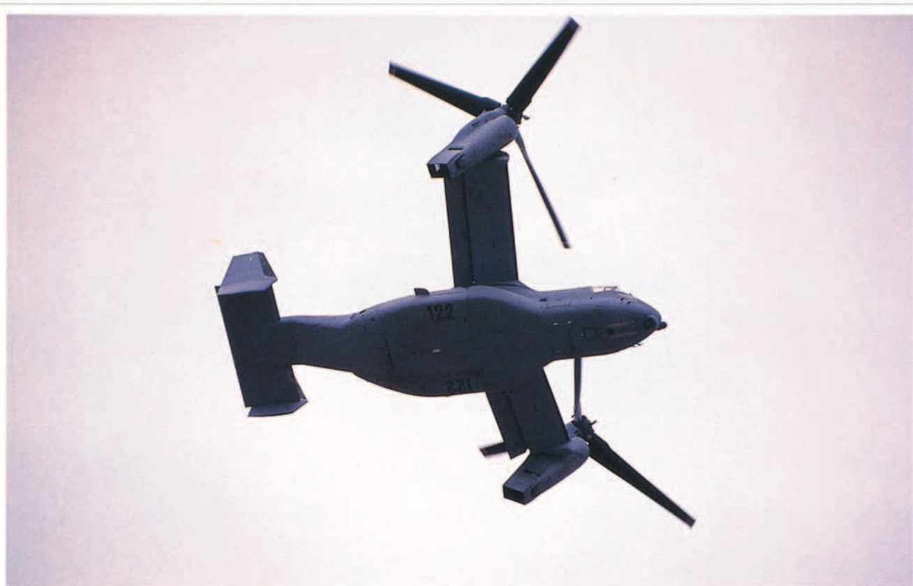
V-22 Osprey en transición a vuelo estacionario con los rotores situados a 45 grados.
