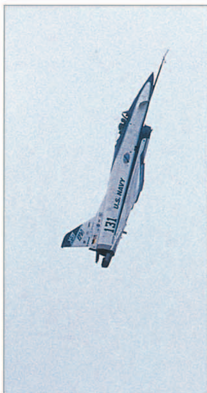
Vuelo estable del X-31 con 70 grados de ángulo de ataque, tal y como delata la posición de sus planos canard.
