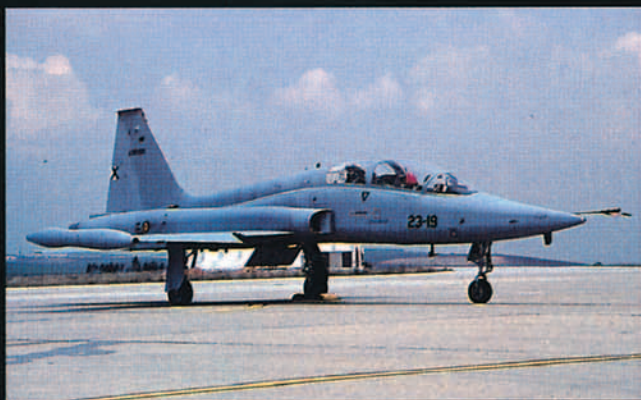
En el Ala 23 de Talavera la Real únicamente los F-5B han sido pintados con un esquema especial en dos tonos de gris que intenta romper la silueta del avión.
