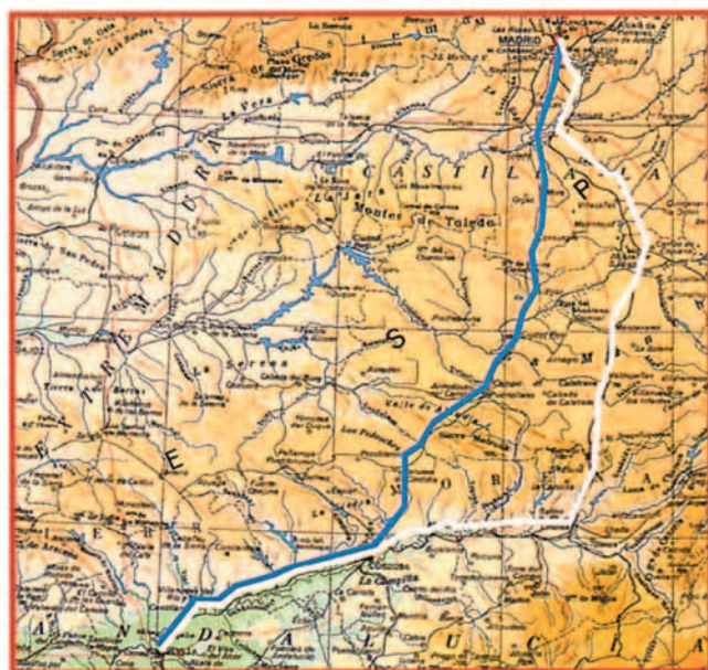
Cien kilómetros menos de trayecto. El mapa muestra el nuevo trazado de la línea Madrid-Sevilla en color azul, que supone cien kilómetros menos de recorrido que el antiguo trazado, señalado en blanco.
