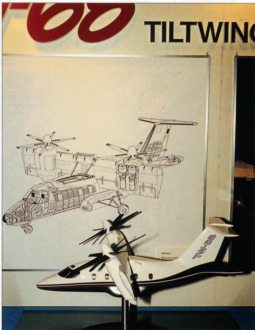
El Ishida TW-68 en maqueta y en dibujo seccionado aparecía ya en configuración cuatrimotor.
