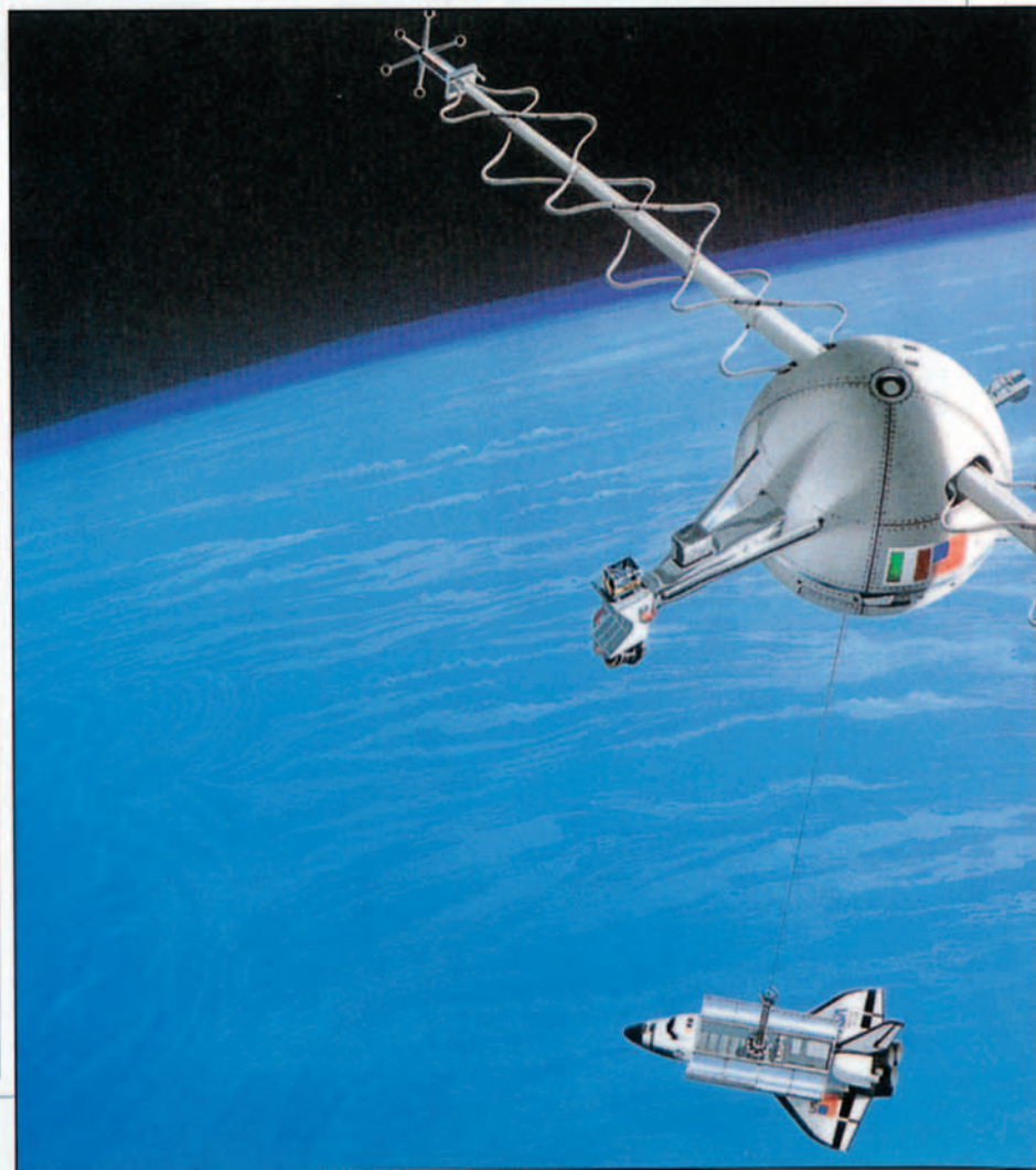
Fig. 13.- Alenia Spazio, del Grupo IRI Finmeccanica de Italia, está realizando bajo contrato con la NASA, investigaciones de generación de energía eléctrica por efecto del campo magnético de la Tierra, como indica este dibujo.
