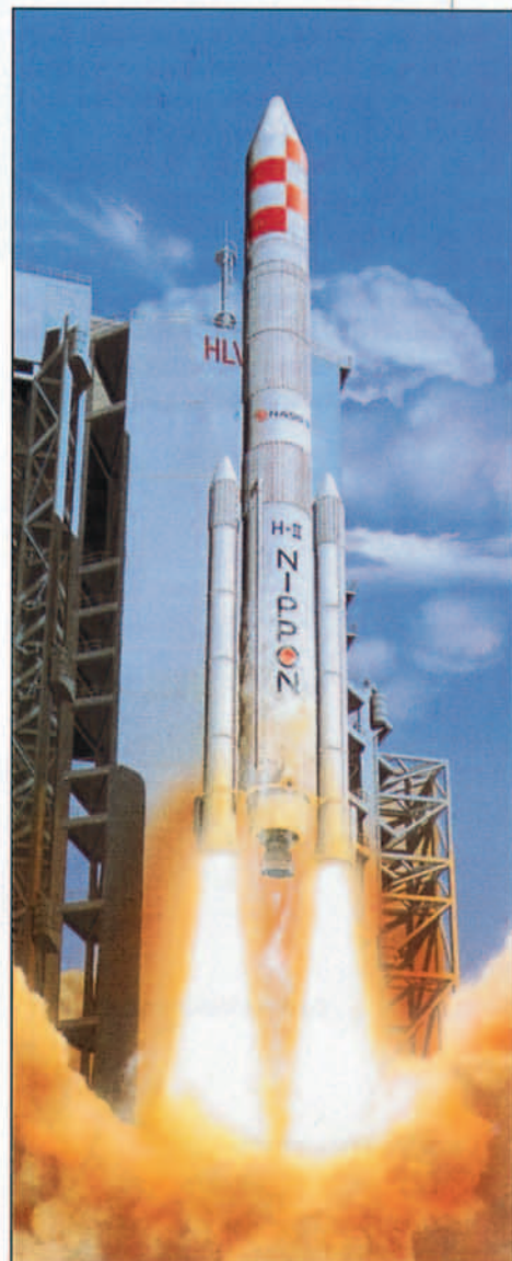
Fig. 5.- Lanzador japonés H-II, de dos escalones de propulsión, con capacidades de lanzamiento de cargas de pago, según la misión: para satelización, hasta 6 Tm., y para misiones interplanetarias hasta 9 Tm.
