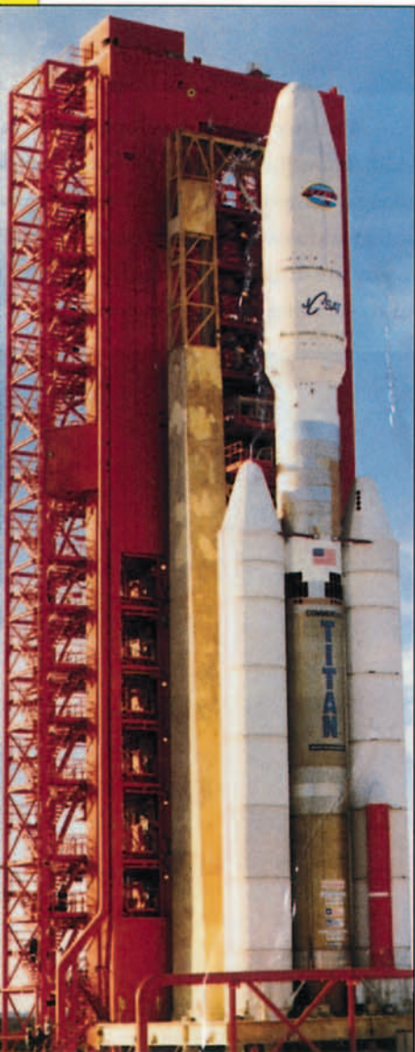
Fig. 3.- Lanzador Titan 3, fabricado por Martín Marietta, con capacidad de lanzamiento para inserción en órbita geostacionaria, de cargas de pago hasta de 4.500 Kg.
