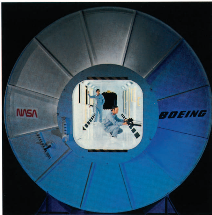
Fig. 11.- Maqueta a escala natural, del módulo habitable de la futura Estación Espacial de la NASA. En la fotografía, especialistas de Boeing montando la maqueta en las instalaciones de Huntsville, Alabama, cerca del Centro de Vuelos Espaciales Marshall, de la NASA.
