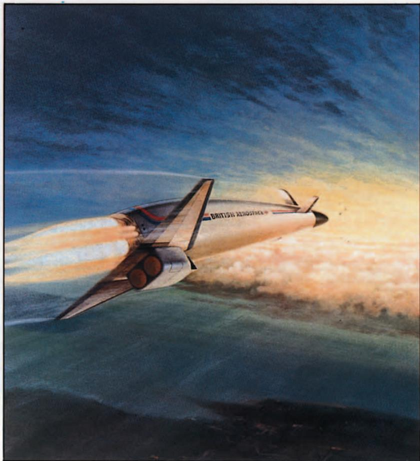
Fig. 10. Configuración de la nave espacial HOTOL (Horizontal Take Off And Landing) en estudio por British Aerospace. En Farnborough '90, BAe ha mantenido conversaciones con la URSS para que el HOTOL pudiera ser lanzado desde un Antonov 225 Myra.
