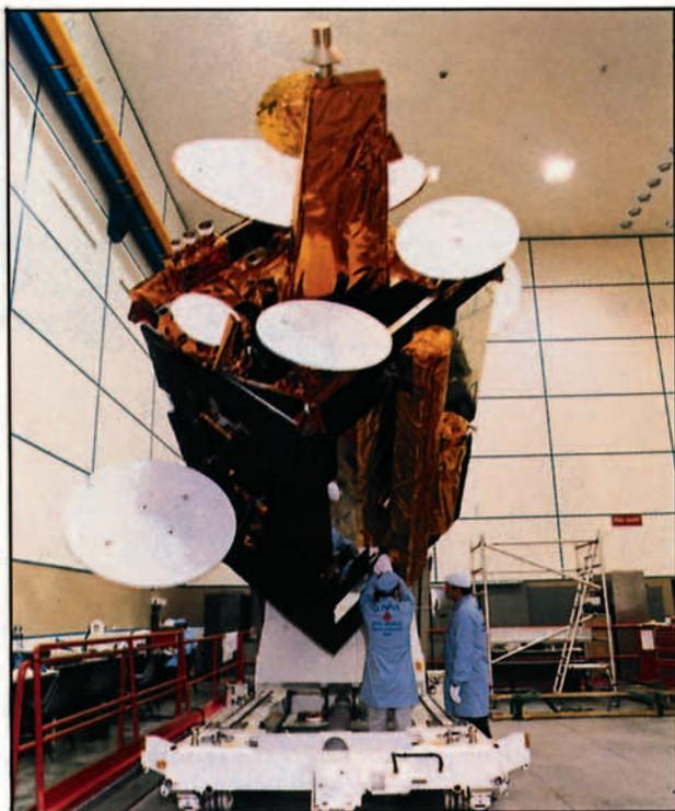
Fig. 5. Montaje final del Olympus 1, satélite de comunicaciones de Diseño BAe. Fue lanzado al espacio el 23 de junio de 1989 en el lanzamiento n.º 32 de Arianspace con un Ariane 3.
