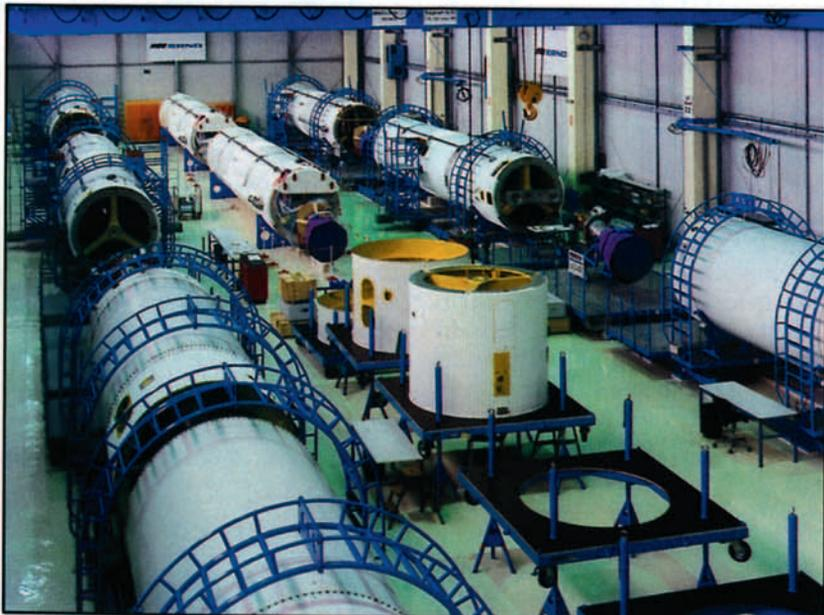
Fig. 4. Producción en serie de los lanzadores de propulsante líquido para los Ariane 4, en la planta que MBB dispone en la ciudad de Bremen.
