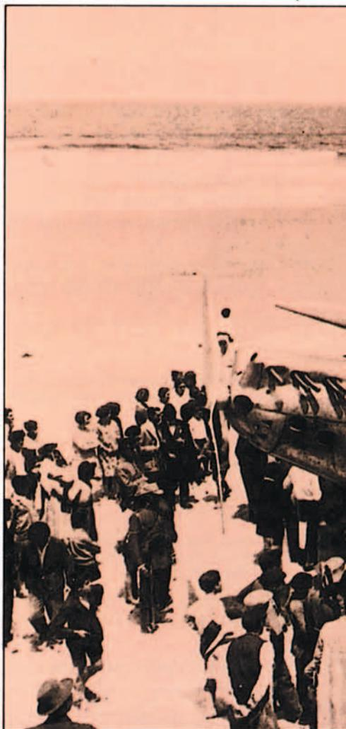
de despegue fracasó al hundirse una rueda del tren de aterrizaje en el terreno, con aparatoso capotaje y destrucción del ala.
