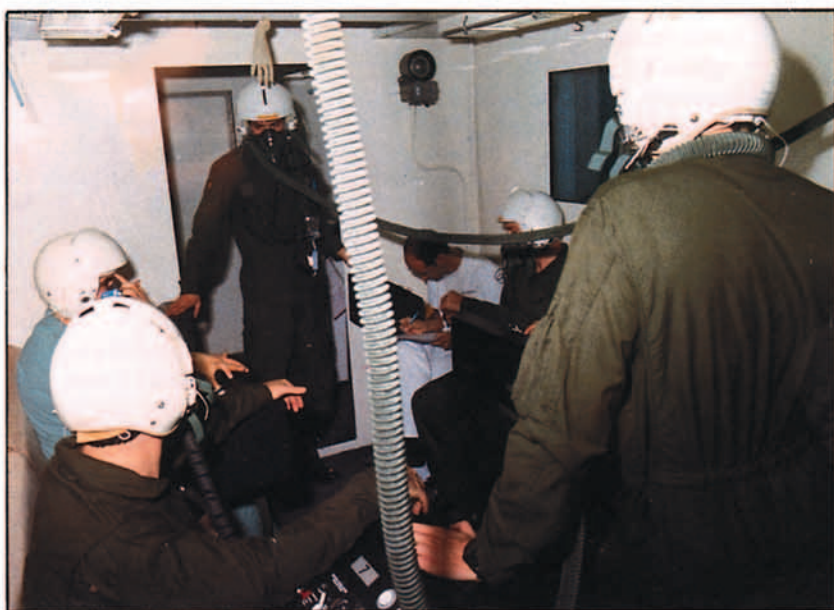
Prueba de Hipoxia a 30.000 pies en la Cámara de Baja Presión del CIMA.
