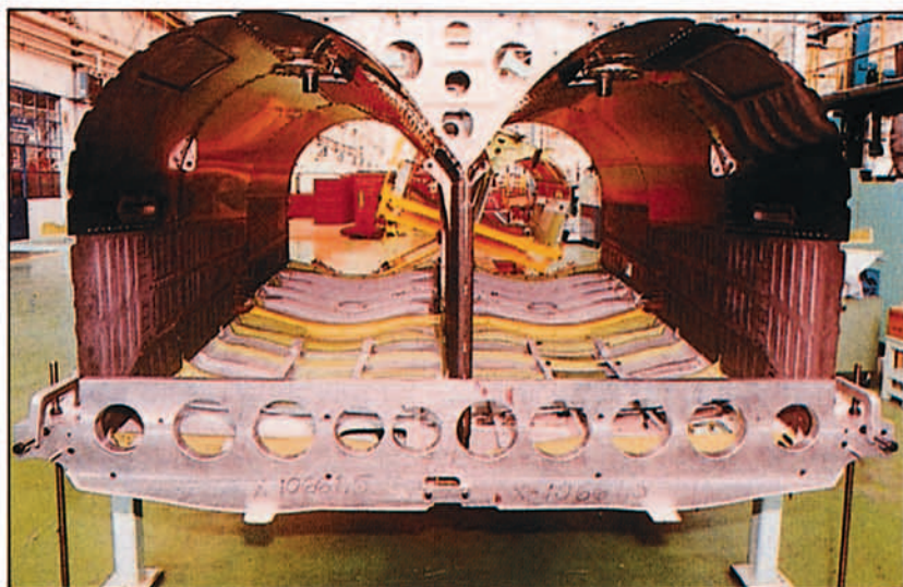
Las tecnologías de conformado superplástico y soldadura por difusión han alcanzado, con el EFA, su madurez.
