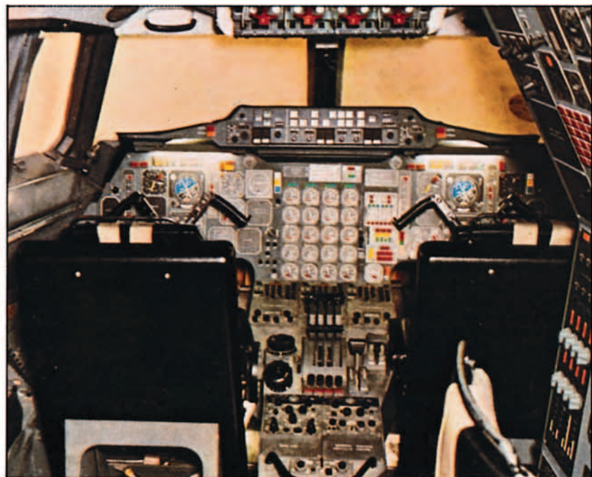
Fig. 7 "Cockpit" del Concorde. El panel de los pilotos tiene los instrumentos situados de forma convencional (vuelo y navegación, repetidos, a la izquierda y derecha, y de control principal de motores en el centro) En el lateral derecho está situado el panel de instrumentos de sistemas, controlado por el Mecánico
