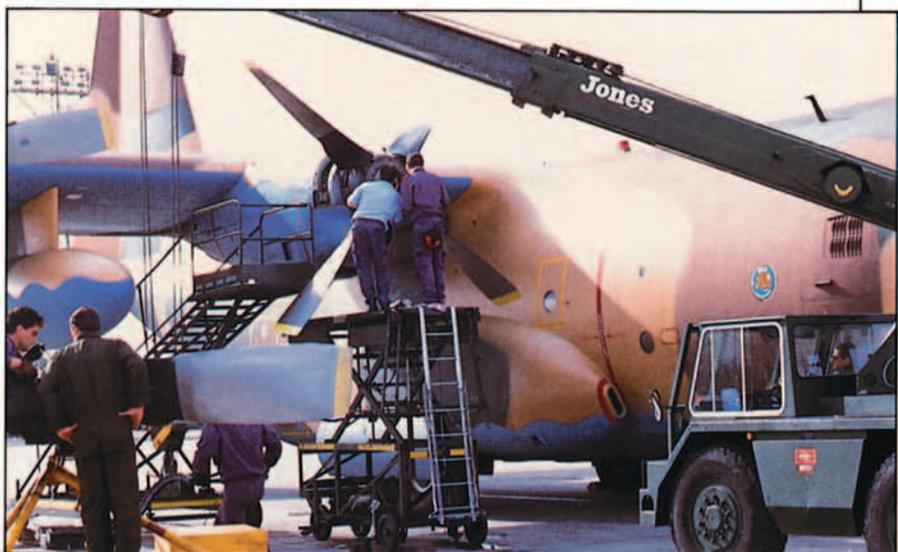
*Un equipo de mantenimiento, en un alarde de eficacia, cambia una hélice en Chipre sin alterar prácticamente el desarrollo de la misión.*
