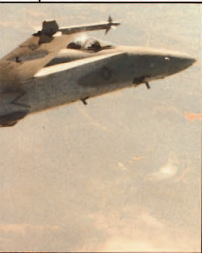
Fig. 9. El F-18 "Hornet", en su versión 2000, salió de fábrica el año 1987, y está considerado como alternativa al ATF, incorporándole variantes aerodinámicas, planos "canard", mayor capacidad de combustible, mayor empuje y aviónica más avanzada.
