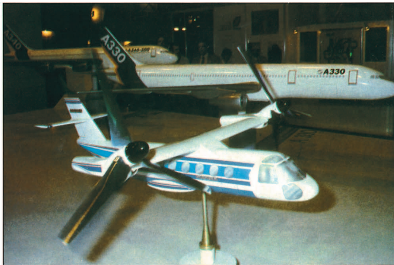
En primer plano una maqueta del "Eurofar" de Aerospaiale con motores basculantes similares al V-22 "Osprey" de Bell-Boeing.
