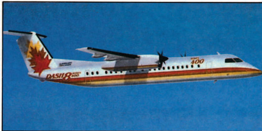
El avión Dash 8-400, propulsado por dos turbopropulsores PW-300/4, que entrará en servicio en 1992.
