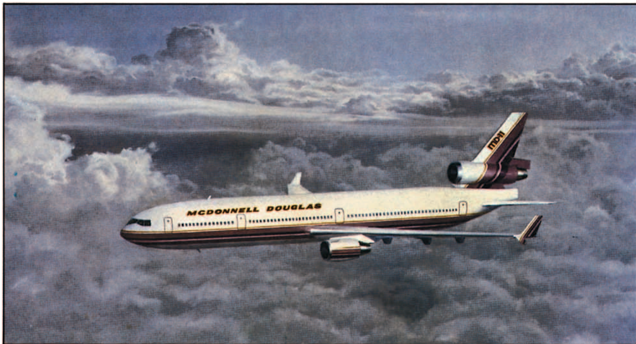
El Mc Donnell Douglas MD-11 hará el "roll out" el próximo mes de abril. Tiene dos características diferentes a todos los MD: "Winglets" en los bordes marginales de las alas, y muy pequeño estabilizador horizontal, que alojará hasta 2000 galones de combustible.
