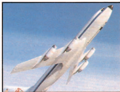
Figura 12. Para una serie de vuelos, de trayectoria parabólica, la NASA ha equipado un KC-135, que puede simular, en periodos de 20 a 30 segundos, condiciones de microgravedad similares a las de las misiones espaciales continuadas.
