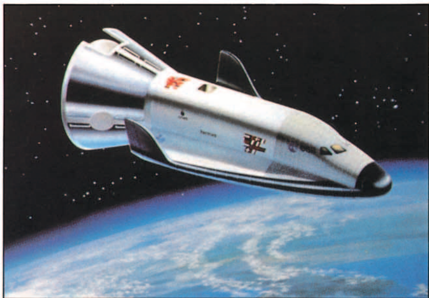
Figura 5. Aerospaciale ha mostrado en Le Bourget 89 la reconfiguración de la nave espacial europea de la ESA, Hermes, que afecta principalmente a la tobera de propulsión, al peso de la nave, que alcanza ya 15 Tm, y al "cockpit" para tres astronautas. La zona presurizada del fuselaje tiene 24 \text{ m}^3 , y es capaz de transportar 3 Tm. de carga para situar en órbita y aterrizar con un peso de 1.5 Tm.
