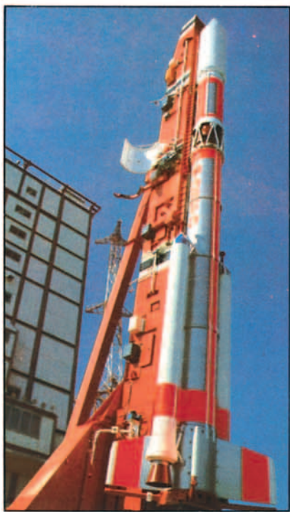
Figura 18. Cohete japonés M-3S II, lanzador de tres escalones, el más potente para envío de grandes satélites artificiales. El primer lanzamiento lo hizo en enero de 1985.
