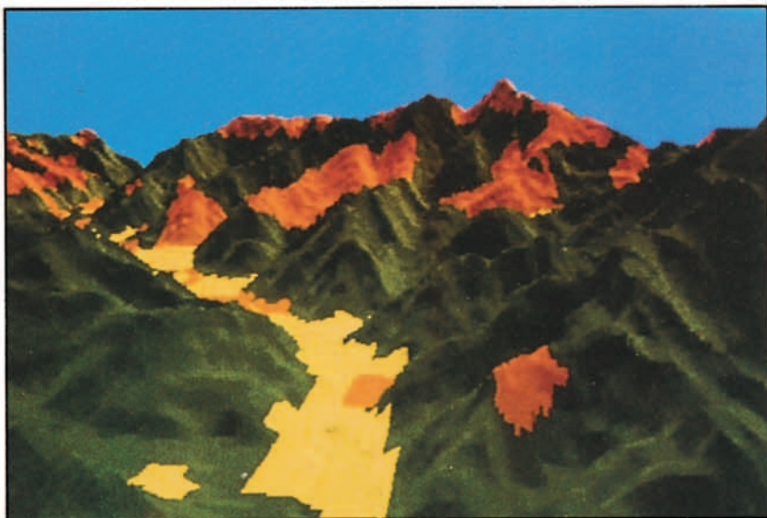
La presentación sintética de la perspectiva de vuelo por delante del piloto, empleando bancos de memoria digital, son la alternativa al uso de radares de seguimiento automático del terreno.
