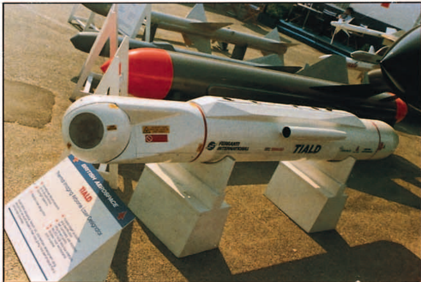
Pod TIALD para designación de objetivos con láser y navegación e identificación por imagen térmica.
