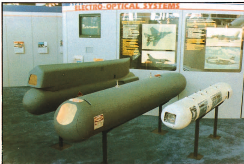
El sistema LANTIRN (a la izquierda) está integrado por un pod de navegación y un pod de designación de objetivos. Y el PATHFINDER es un pod FLIR (a la derecha) modular derivado del anterior y adaptable a una amplia gama de aeronaves.
