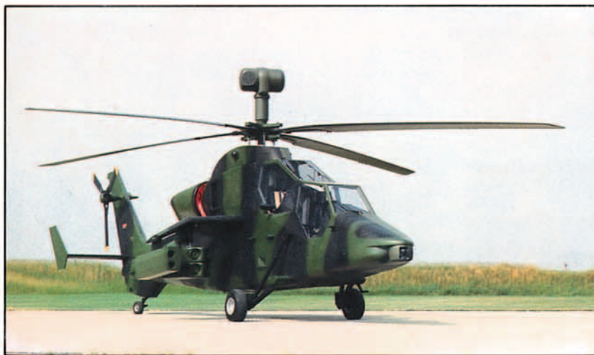
Maqueta del helicóptero de ataque franco-alemán PAH-2/HAC Eurocopter, desarrollado por MBB y Aerospatiale.
