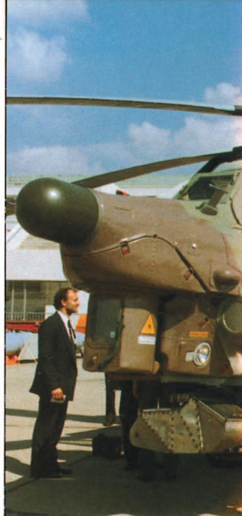
La auténtica novedad de este año ha sido el helicóptero soviético de ataque Mil Mi-28 Havoc. En esta vista se aprecia la colocación de las cabinas para la tripulación y el radar en el morro para el misil AT-6 Spiral.
